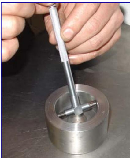
Los calibradores telescópicos sirven para la medición de diámetros de agujeros o anchos de ranuras. Las dos puntas de contacto se expanden mediante la fuerza de un resorte. Una vez colocadas en la posición adecuada, se fijan y se remueve el calibre. El tamaño final puede obtenerse midiendo sobre las puntas de contacto con un calibrador o micrómetro.
