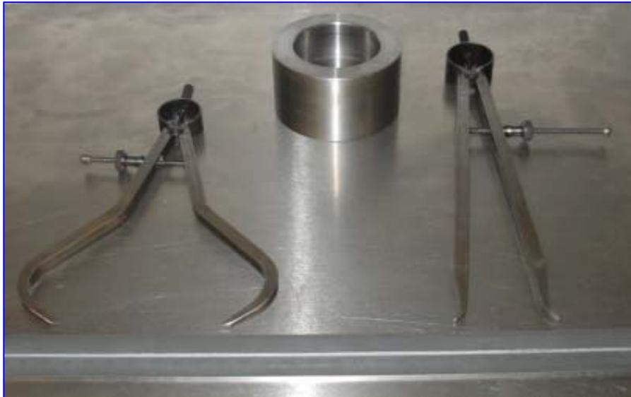
**Figura 26.** Compases de medición externa y medición interna.
