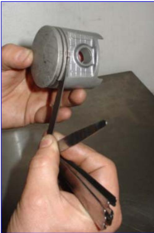
**Figura 22.** Galgas en función de medir el espesor de la ranura.
