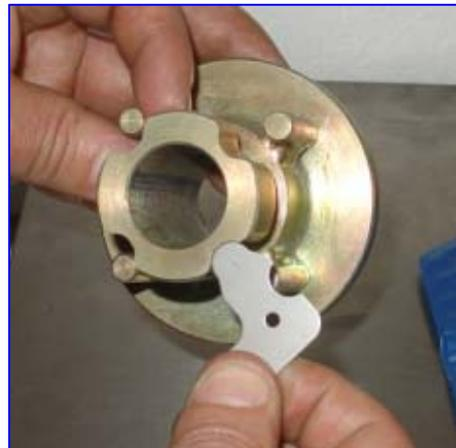
**Figura 23.** Galgas en función de medir el radio de la pieza.
