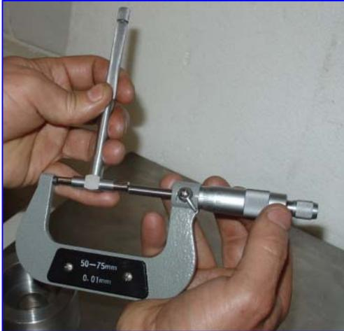
El micrómetro es una herramienta para tomar mediciones más precisas, que las que se toman con el calibrador Vernier. El micrómetro posee un tornillo de alta precisión el cual permite el pequeño movimiento del husillo, posteriormente es el que determinará la medida de la pieza que se este calculando.
