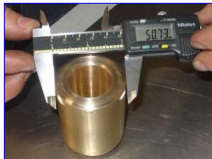
**Figura 16.** Calibrador Vernier digital en función de medición de exteriores.
