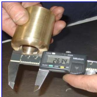
**Figura 15.** Calibrador Vernier digital en función de medición de interiores.
