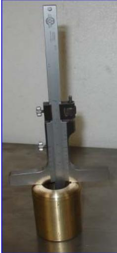
El medidor de profundidad esta diseñado para medir las profundidades de agujeros y ranuras, así como la diferencia de altura entre peldaños y planos. Sus sistemas de graduación y construcción son básicamente los mismos que los empleados en los calibradores Vernier.
