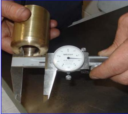
**Figura 14.** Calibrador de carátula en función de medición de interiores.
