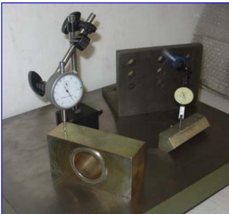
Instrumento de medición en el cual un pequeño movimiento del husillo se amplifica mediante un tren de engranajes que se mueven en forma angular. Una aguja es la encargada de indicar el resultado sobre la carátula del dispositivo. La aguja indicadora puede dar tantas vueltas como lo permita el mecanismo de medición del aparato.
