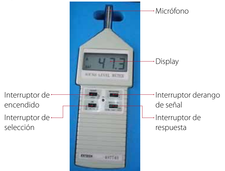
Figura 7. Partes del Sonómetro EXTECH, modelo 407740.
